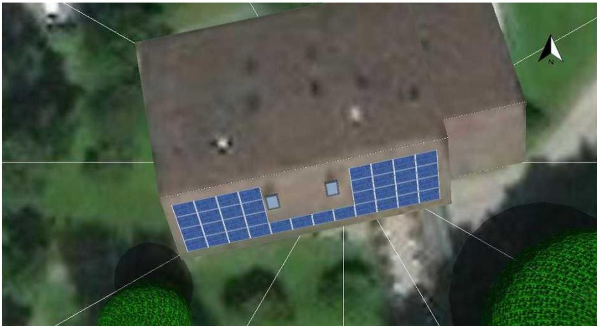
Abbildung 5-13: Geplante PV-Anlage auf dem Dach Haus des Gastes.
